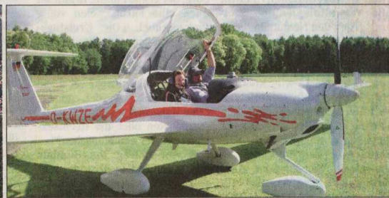
Klappe zu und los geht's: Harald Schliedermann und Lena Thiel im Motorsegler vom Typ Diamond Super Dimona. Das Flugzeug verbraucht 16 bis 18 Liter Benzin in einer Stunde. 80 Liter passen in den Tank
